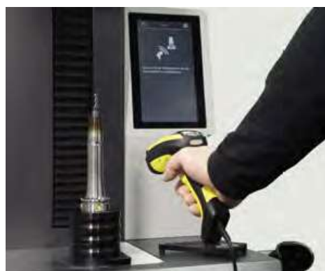
Odczytywanie paramterów za pomocą ręcznego sknaera kodów QR * opcja
